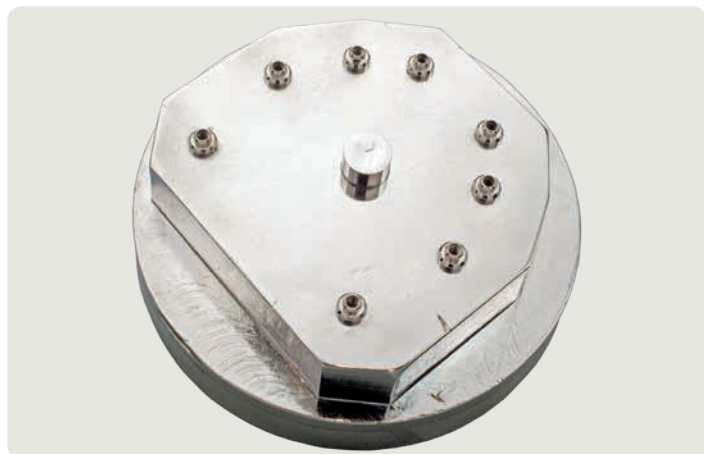
Il modello di prova n. 0 è un modello d'acciaio fresato, con modelli impianti avvitati.
